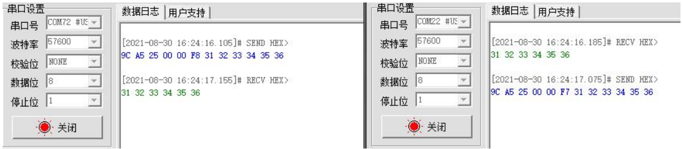
图 16 定点传输 WMODE=4 数据示例
